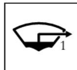
Bilge Pump (Number 1) 舱底泵 1 号
