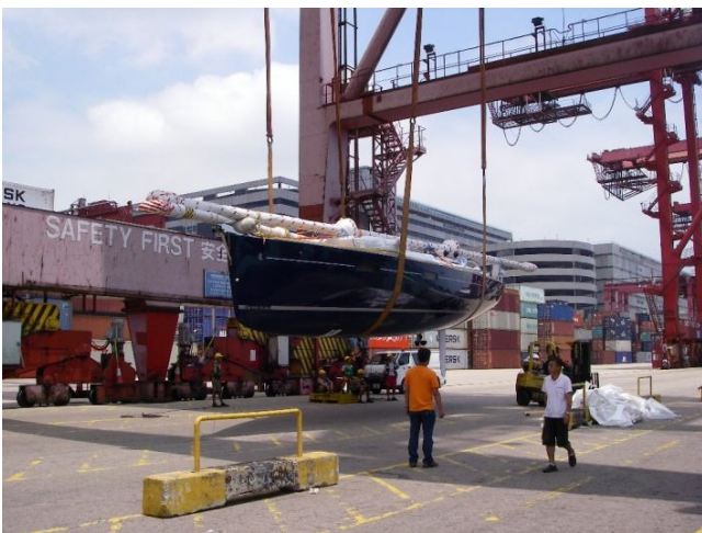
將船吊起並安裝方向舵
