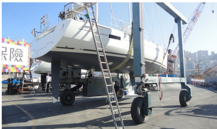
吊索將船吊住以進行油漆修補
