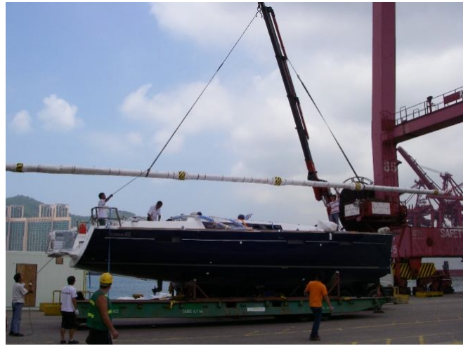
拆開包裝、檢查並將桅杆放置在船頂
