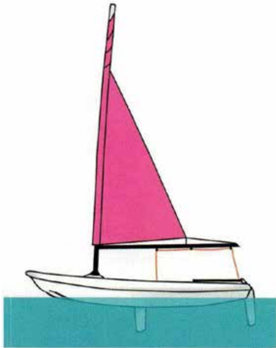
Partially roll the mainsail around the mast to reef a singlehanded dinghy. 单人小帆船缩帆，通常是把主帆的一部分卷在桅杆上。
