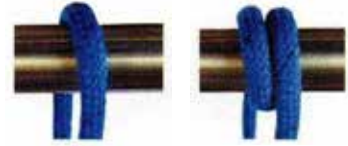
A simple passing turn (left) and a round turn (right). 将绳子绕标杆一次（左图），然后再绕一次（右图）。
