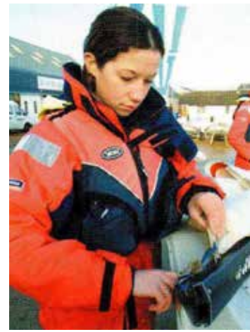
Step 5 Fasten the outhaul to the mainsail. 第五步, 将后拉索系在主帆上。 Step 6 (No picture) attach the mainsail halyard. 第六步, (无图)连接主帆升降索。
