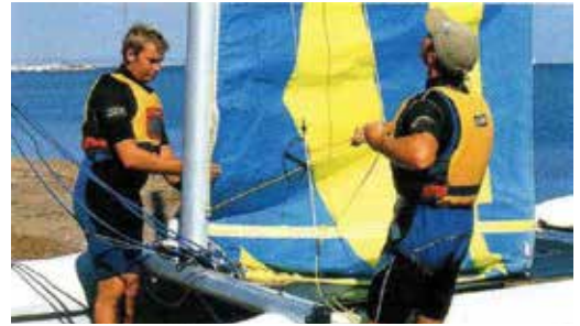
Step 2 If the mainsail jams, stop pulling and make sure the luff is able to slide smoothly into luff groove. 第二步，在拉升降索时，如果主帆卡住，马上停止进行调节，确保帆边缘能够平滑地进入凹槽。
